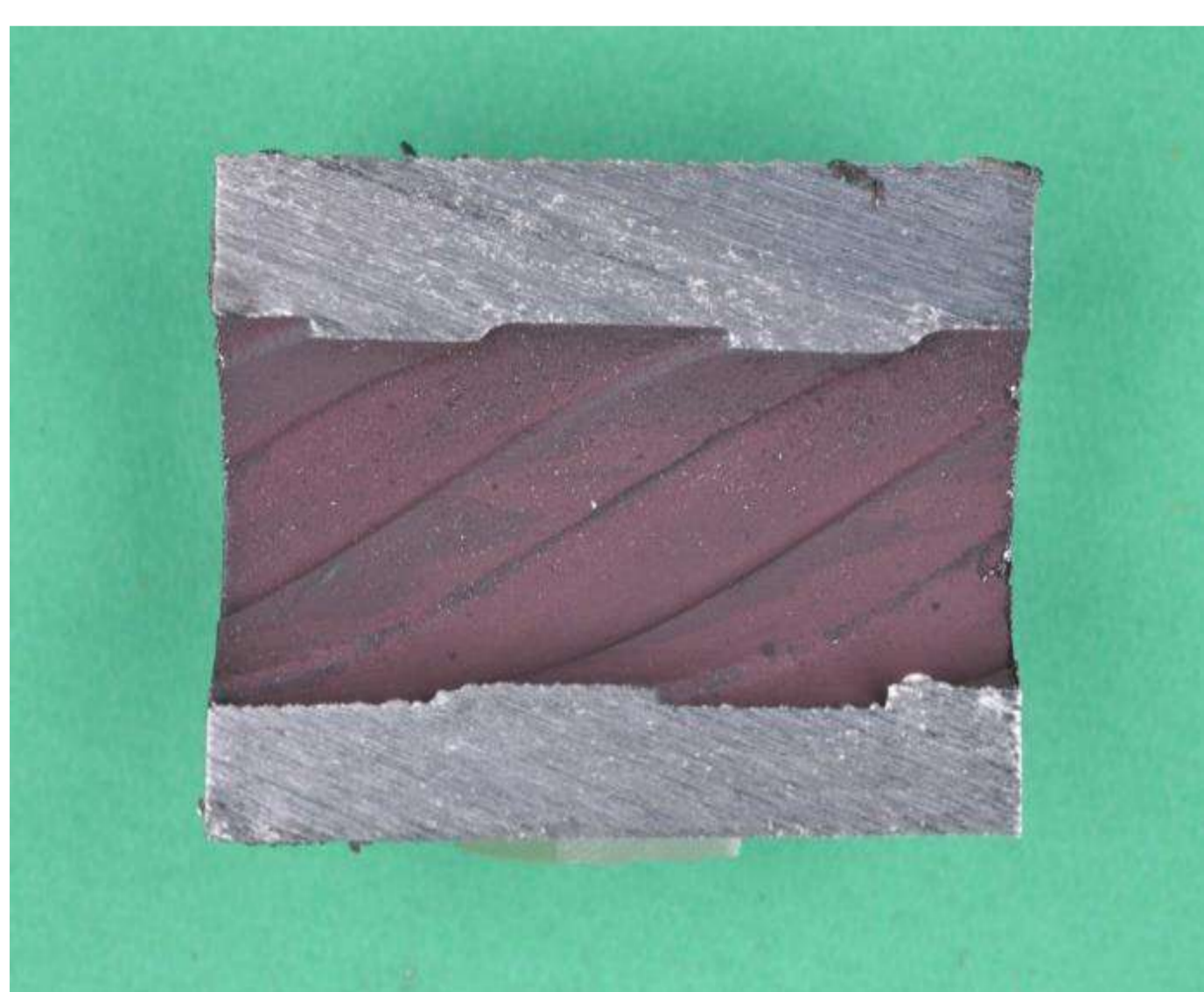
鉄粒子が付着した蒸発管の内面写真
