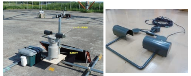
第1図 計測地に設置したレーザー雨滴計（右：単体）
