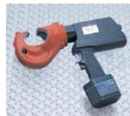
12t小型圧縮機 (機材質量6kg)
