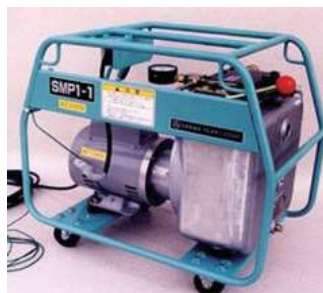
100t油圧ポンプ (機材質量60kg)
