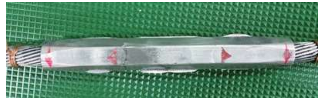
第3図 圧縮管 (圧縮直後写真)
