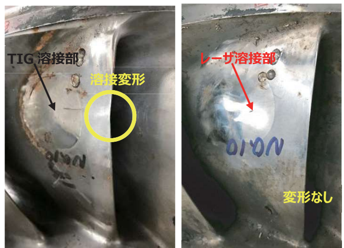
第7図 溶接修理後の羽根表面の観察結果（6回修理）
