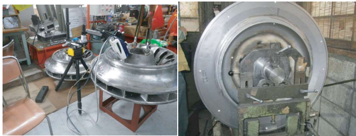
第4図 残留応力測定および動バランス試験状況
