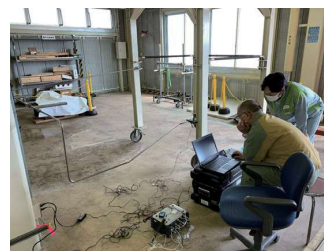
破断配管を作業場で仮固定し、再現試験実施
