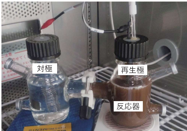
第3図 微生物によるCO 2 固定化のラボ試験装置
