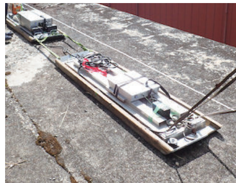
第3図 地中レーダ探査状況
