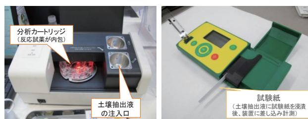
吸光式簡易分析装置 (エア・ウォーター製、型式:EW-THA1J) 反射式簡易分析装置 (メルク製、型式:RQフレックス20)
