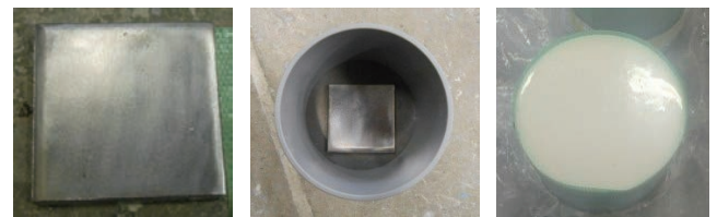
(a) 磨き鋼板 (b) 鋼板設置 (c) エポキシ被覆 第2図 供試体作製状況
