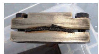
第4図 CBB試験片 (左) と組み上げ時の写真 (右)
