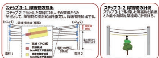
第8図 伐採対象箇所抽出と最接近距離計測のステップ
