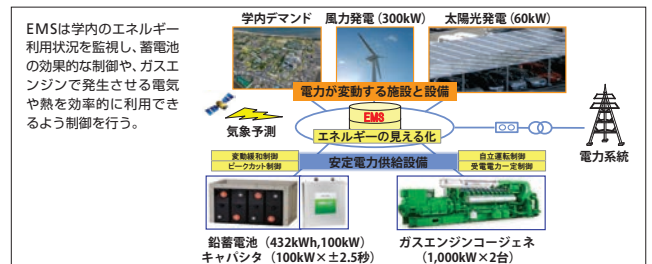
第2図 スマートキャンパスの導入設備
