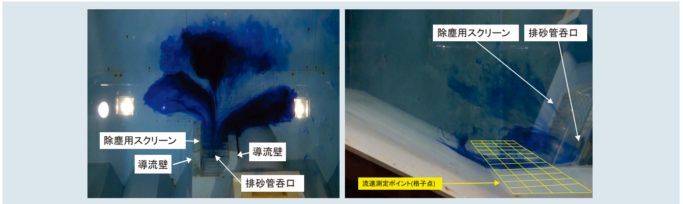
第3図 排砂管に取水される貯水の流動形態 【左図：水槽上部より撮影、右段：水槽側面より撮影】
