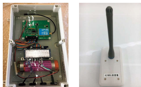
第3図 FSK試作機(左：子局、右：親局)
