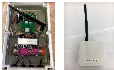
第2図 LoRa試作機(左：子局、右：親局)
