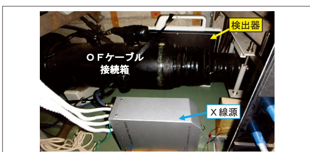
第4図 X線撮影状況(接続箱右側)
