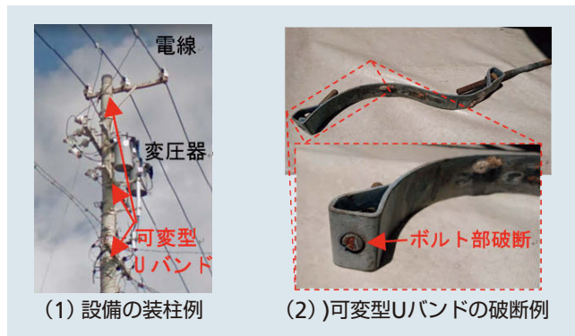
第3図 装柱例と可変型Uバンドの破断例
