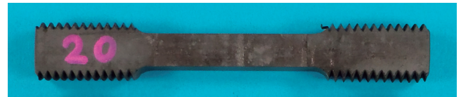
第5図 ボイラ過・再熱器管材のクリープ寿命消費材
