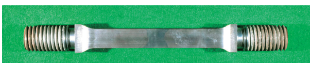
第4図 高温再熱蒸気管溶接継手材のクリープ寿命消費材の外観
