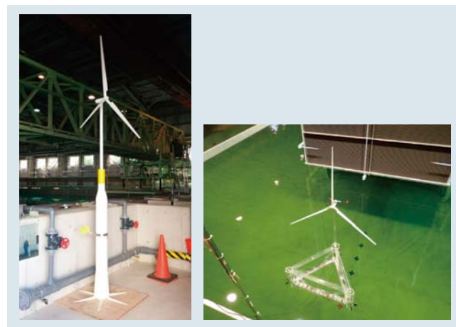
第1図 模型の外観(左図：スパー型、右図：セミサブ型)
