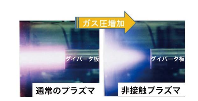
第4図 非接触プラズマ生成実験の写真
