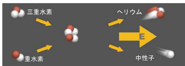
第1図 重水素と三重水素を用いた核融合反応
