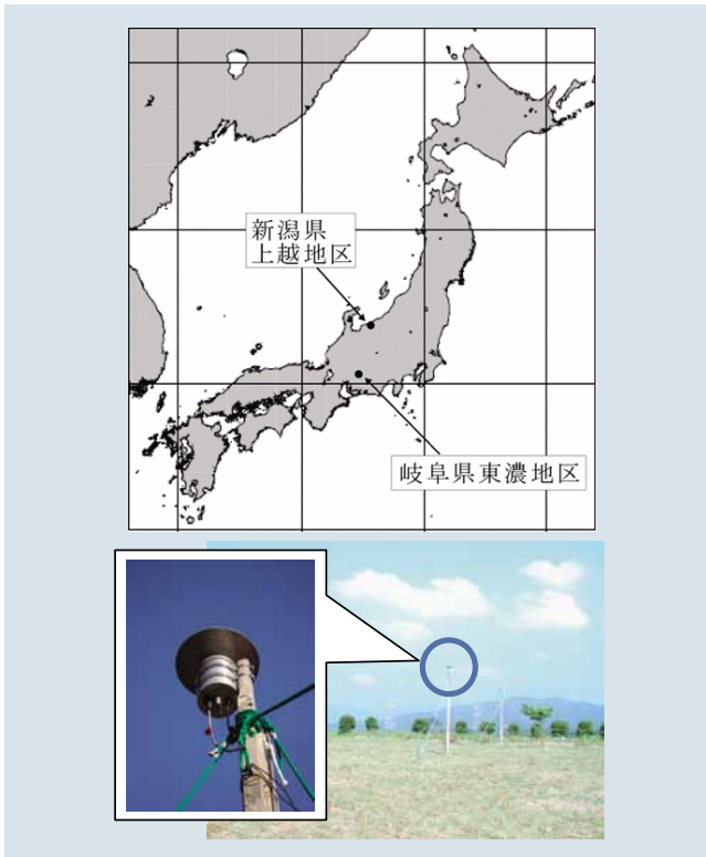
第2図 観測場所およびVHF広帯域干渉計(アンテナ) 設置状況
