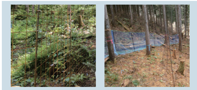
第1図 侵入防止柵(左:鋼製柵 右:繊維製柵)
