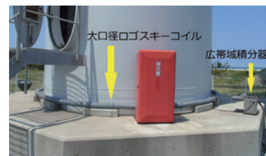
第1図 大口径ロゴスキーコイルを用いた雷撃検出装置
