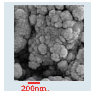
第3図 脱硝触媒表面の付着物
