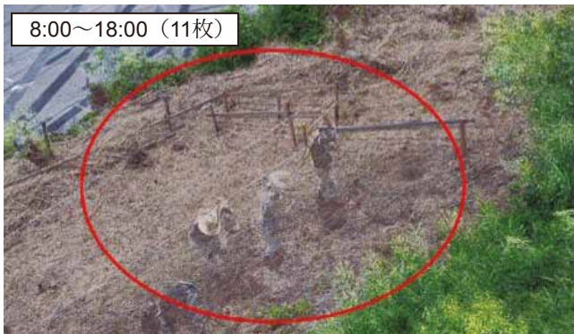
第4図 差分画像の積算による集約画像
