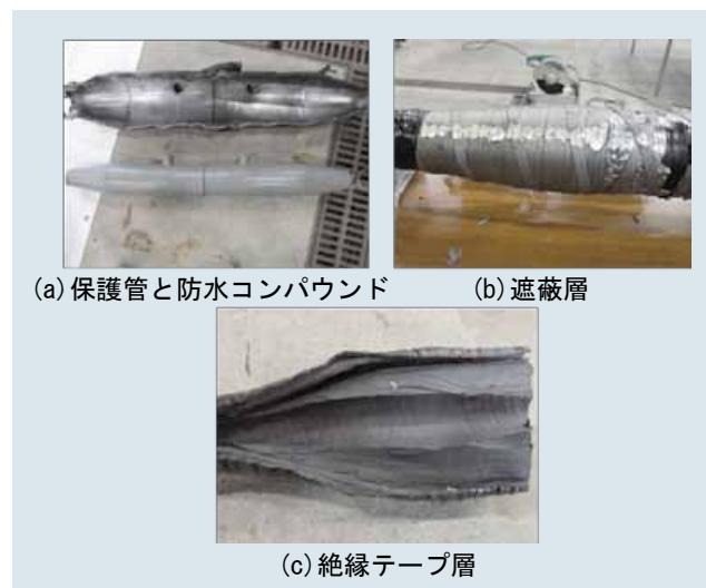
第2図 TJの解体写真（線路A）
