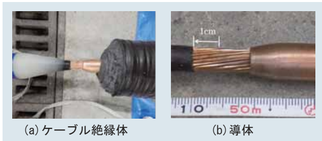
第3図 TJ内部のケーブル部(線路A)
