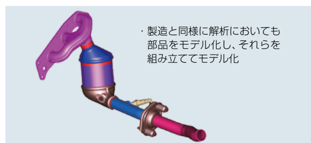
第1図 自動車エキゾーストマニホールド解析モデル
