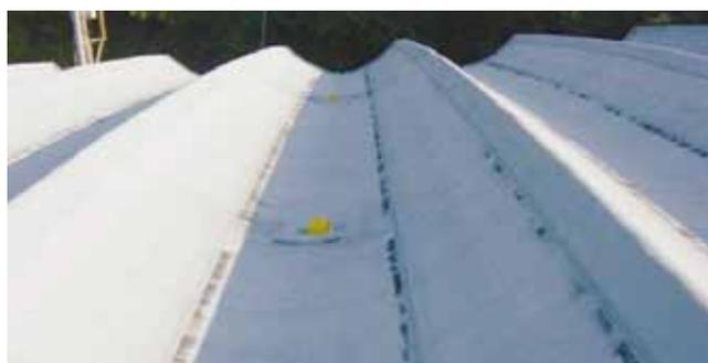
第1図 固体廃棄物貯蔵庫1号棟屋上設置の環境用電子線量計(黄色のBOX)
