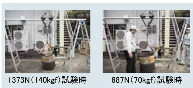
第6図 強度検証状況
