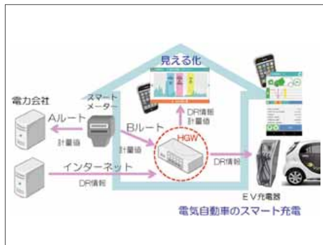
第2図 HGWの接続図
