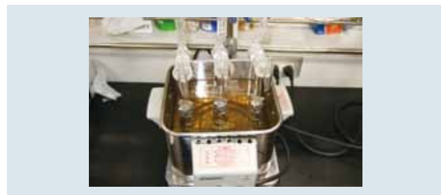
第3図 オイルバスによる加熱装置
