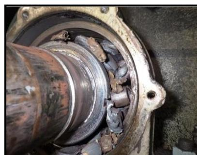
分解点検で確認した損傷状態の軸受
