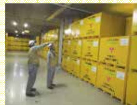
運転中に発生した低レベル放射性廃棄物の保管の様子
