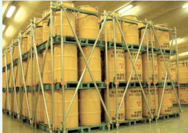
最上段ドラム缶を4本ごとにベルトで固縛し、さらに隣接するパレットを連結
