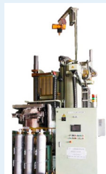
アイシン高丘(株)さまに導入されたアーク式取鍋加熱装置
