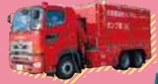
④ 取水ポンプ車(車両型)
