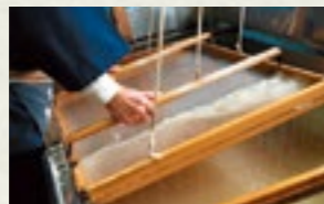
漚舟に、細かくほぐした楮の繊維、水、粘液を入れてよく混ぜ合わせ、簀桁という枠のような道具を使って紙をすく。
