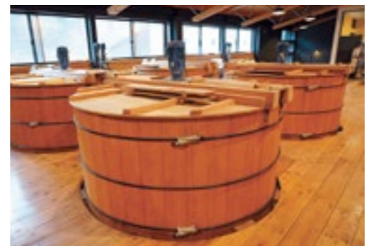
静岡産の杉材でつくられた発酵槽。杉が清々しくやさしく香る。
