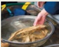
紙の原料・楮の繊維を取り出すため煮熟したあと、付着しているチリやゴミを流水の中、手作業で丁寧に取り除く。
