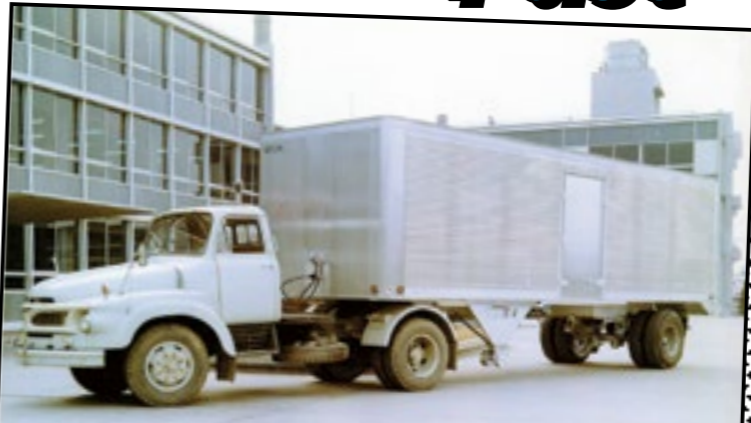
1965年(昭和40年)に製造開始した第一号のトレーラー「ドライバンセミトレーラー(試作車)」。当時はボンネットがあった。
