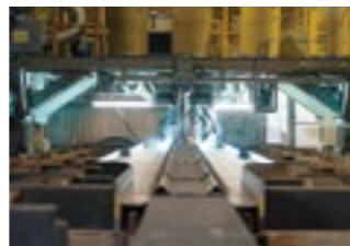
トレーラーの土台となる「メインレール」の溶接は、ロボットによる自動溶接で行われる。
