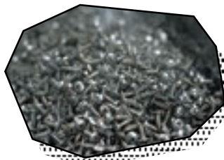
←加工前、ワイヤー状のねじ材料。 →必要な長さに切断し、圧を加えてねじの頭がつくれた後、転造*によって差し込むギザギザの部分“ねじ山”をつくる。
