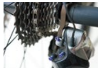
ねじを硬質なチタンにすることで、マシンの状態がよりレーサーの体に伝わり、パフォーマンスアップにつながるそう。
