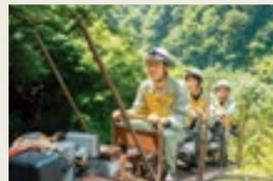
発電所の上に設置された水槽や水圧鉄管の点検時に使用する作業用モノレール
