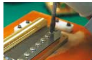
噛み合い調整の様子。振動板の傾きや位置の微妙な違いで音色が変わる。
