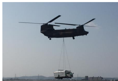
空輸型大型発電機車の空輸訓練
