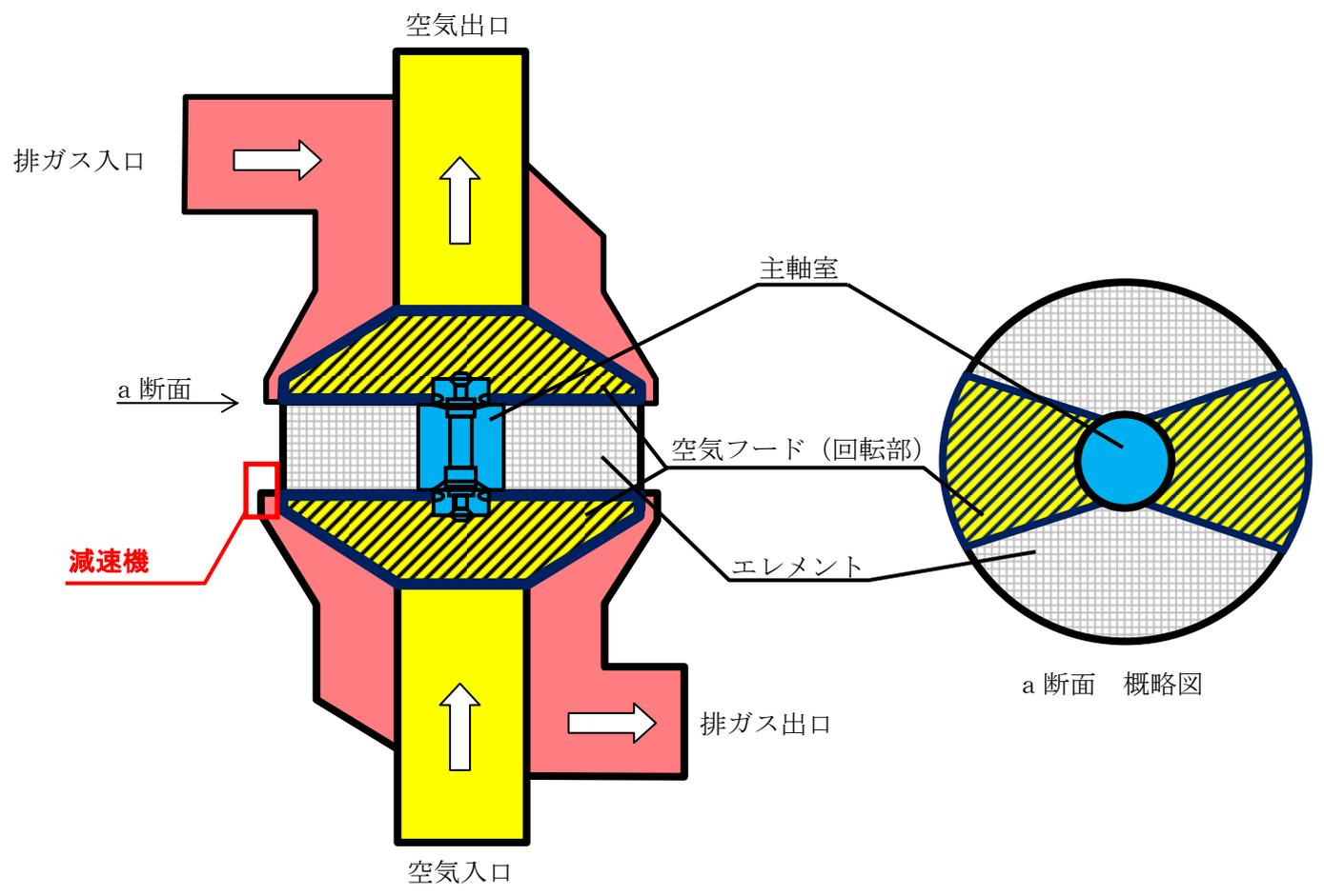
〈 空気予熱器 空気／排ガス流れ概略図 〉
