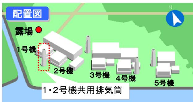
発電所敷地内には、敷地を代表する気象データを取得するための観測装置を設置している「露場」があり、今回のドップラーソーダも、この露場に設置する予定です。
