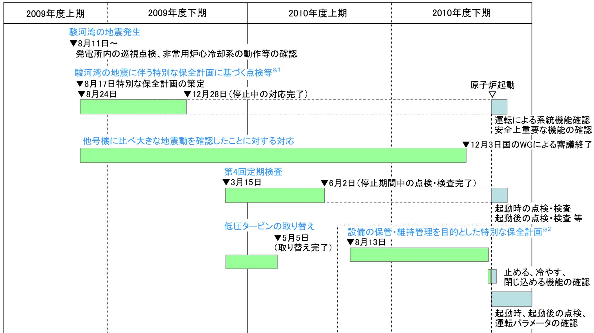
※1 「駿河湾の地震に伴う特別な保全計画」とは、2009年8月11日に発生した駿河湾の地震に伴い、安全・安定運転に必要な設備の健全性を確認するための点検計画(地震観測記録を用いた設備健全性の評価を含む)をまとめたものです。
